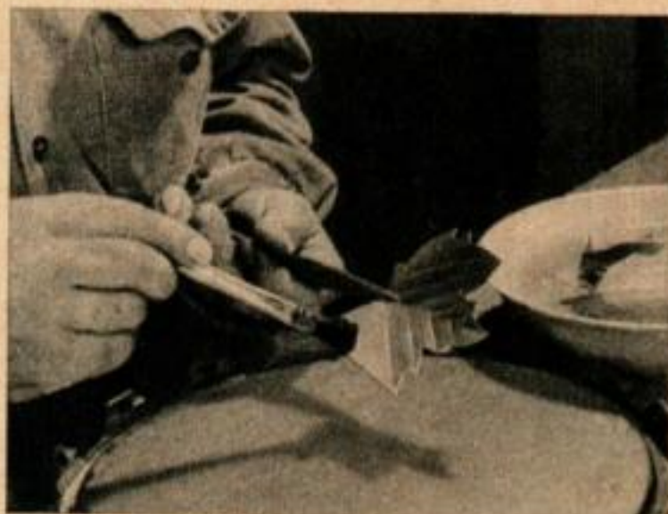
Les feuilles sont enduites de fondant acide avant d'être colorées ; faites-les tremper dans l'acide pendant quelques secondes, ou appliquez le fondant avec un pinceau.
