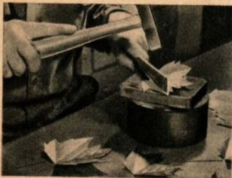
L'estampage, ou repoussage, du métal s'effectue en frappant vivement sur une barre de métal à bord de coupe émoussé, tandis que la feuille repose sur un bloc de bois dur.
