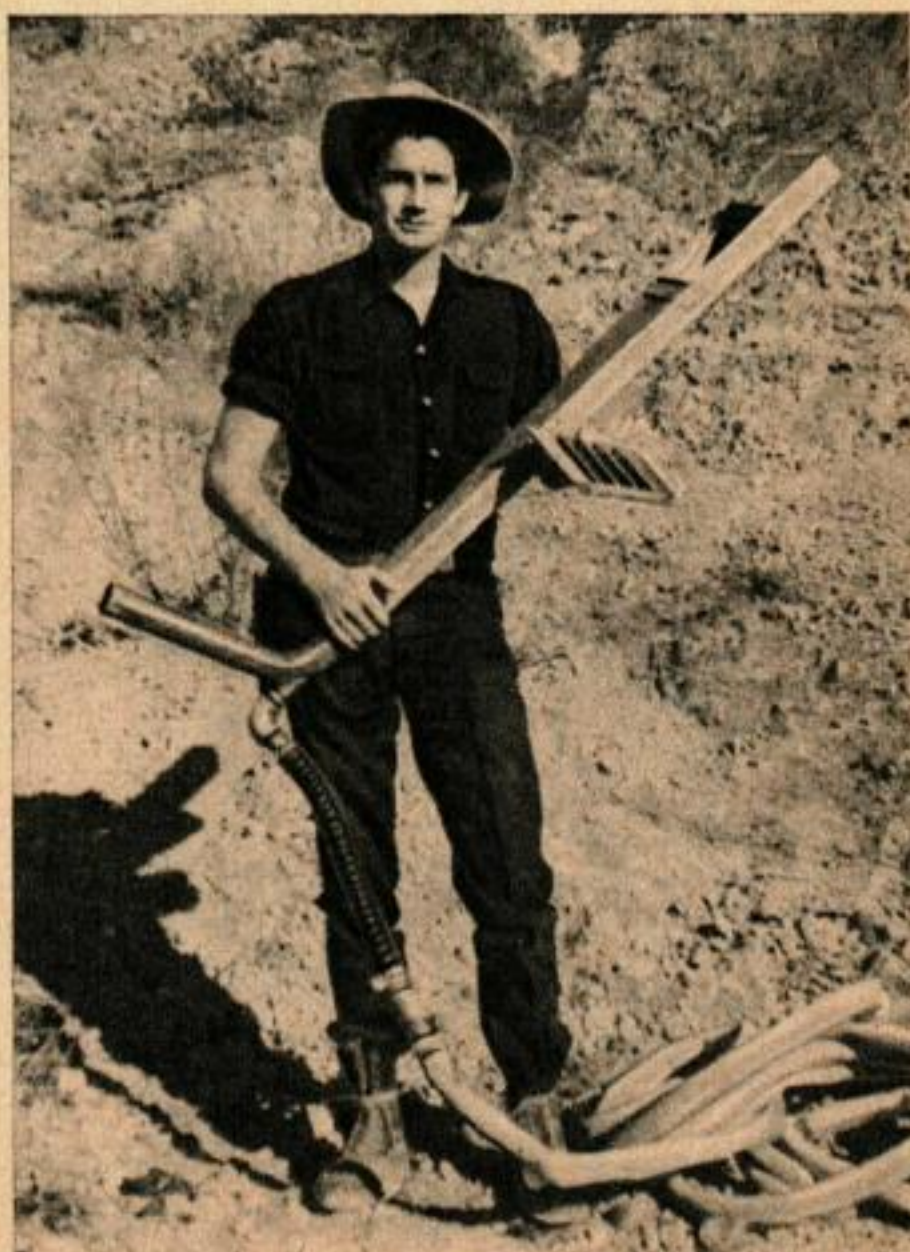
Cette équipe fille et garçon « travaille » un fond de rivière rocaillieux avec des leviers et un sac à échantillons. Ci-dessous, un plongeur vétérán de Los Angeles présente sa dragueuse portative. Dans sa main gauche, il tient un petit « sluice ». Les distributeurs californiens n'arrivent pas à satisfaire à la demande de matériel de dragage à petite échelle.
