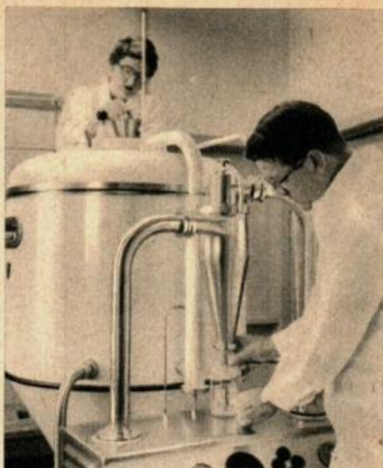
Le séchoir-pulvérisateur de l'Institut convertit les liquides en poudre sèche. Il sert à l'étude de nouvelles préparations alimentaires.
