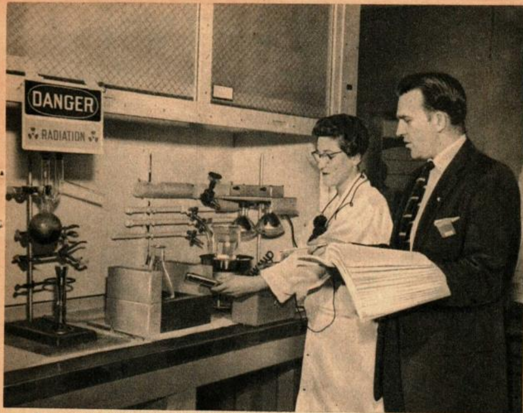
Des isotopes radio-actifs sont ajoutés aux insecticides et aux détergents utilisés pour protéger et laver les légumes, afin qu'un technicien équipé d'un compteur spécial puisse vérifier l'efficacité des nouveaux procédés de lavage. L'un de ceux-ci utilise les ondes soniques.
