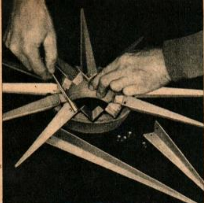
Du ruban caoutchouté disposé autour du bord supérieur des encoches en V forme une cale d'épaisseur qui fait pointer les rayons vers le haut.
