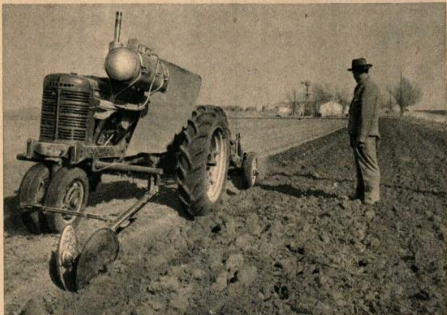
Les disques de guidage suivent le sillon ; s'ils quittent celui-ci, un interrupteur d'allumage automatique arrêtera le tracteur.
