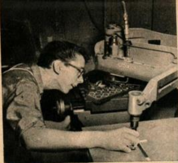
3. Les modèles-pilotes sont alors fractionnés pour fournir les patrons des moules des nombreuses pièces qui composent les nécessaires.
