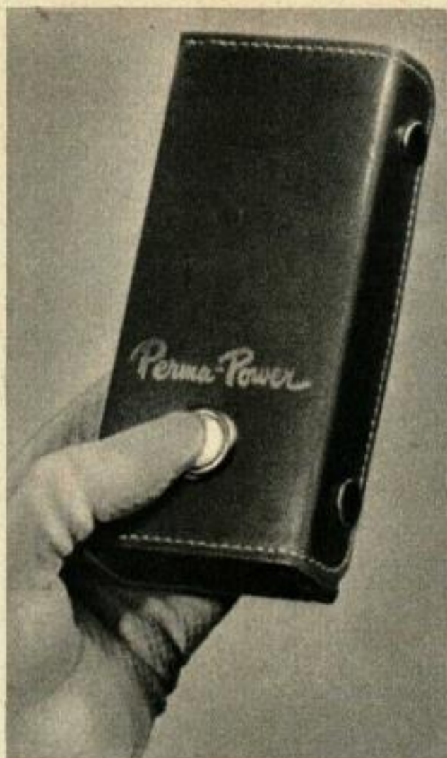
Dispositif d'ouverture de porte de garage commandé par radio et contenu dans un sachet de cuir, facilement transportable. La pression du bouton fait ouvrir la porte.
