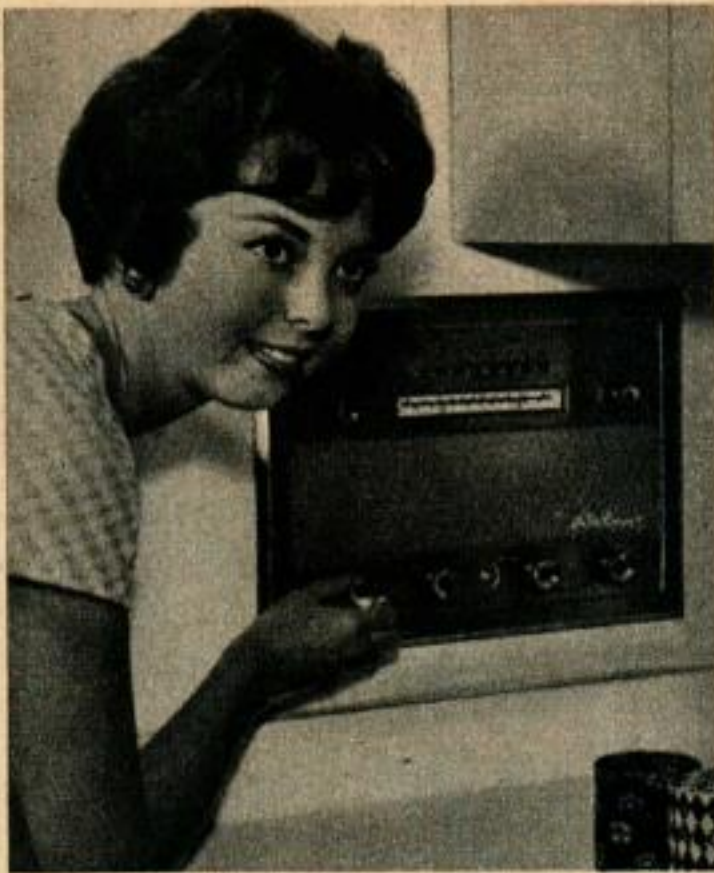
Système d'intercommunication intégré permettant aux habitants d'une maison de parler à ceux qui sonnent à l'entrée et de les inviter à entrer.
