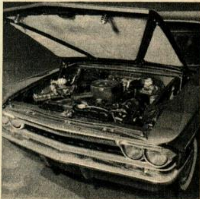
Un large capot se relève pour révéler le moteur de la F-85, dont les parties exigeant de fréquents services sont très faciles à atteindre.
