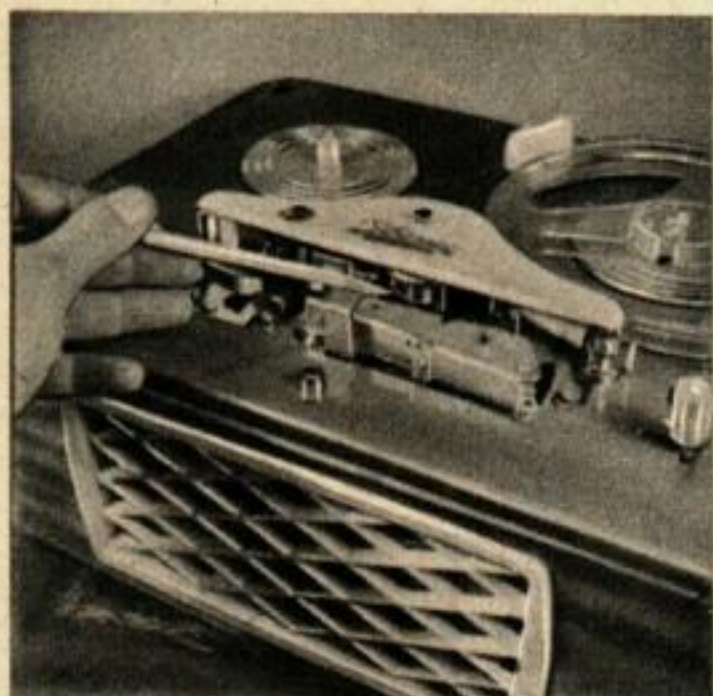
Les têtes à position fixe comme sur le Tandberg ne permettent que l'emploi des bandes à demi-piste, enregistrement et reproduction.
