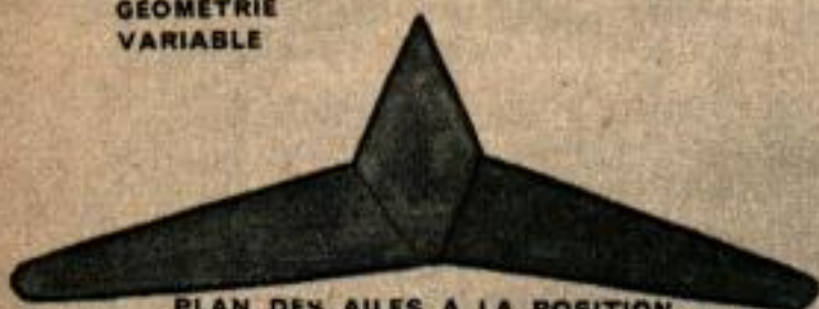
PLAN DES AILES A LA POSITION DE DÉCOLLAGE ET D'ATERRISSAGE
