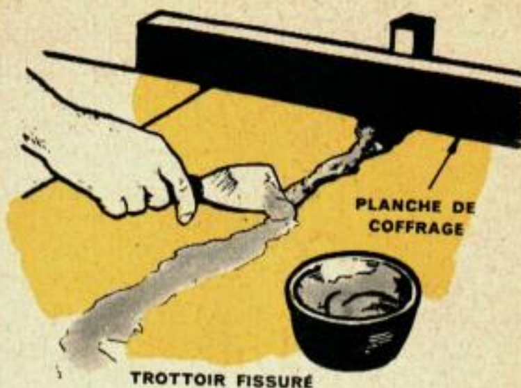
4. Une planche tenue par un piquet contre le bord d'un trottoir confine le matériau de réparation dans la fissure et permet de réaliser une très nette réfection.
