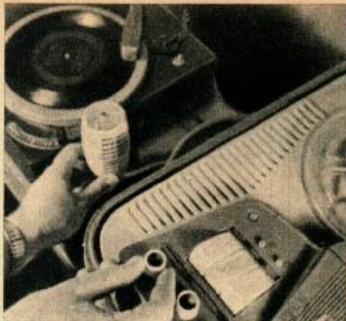
Des entrées séparées microphone et radio-phono chacune avec sa commande de gain, permettent un mélange interne sur le Norelco.
