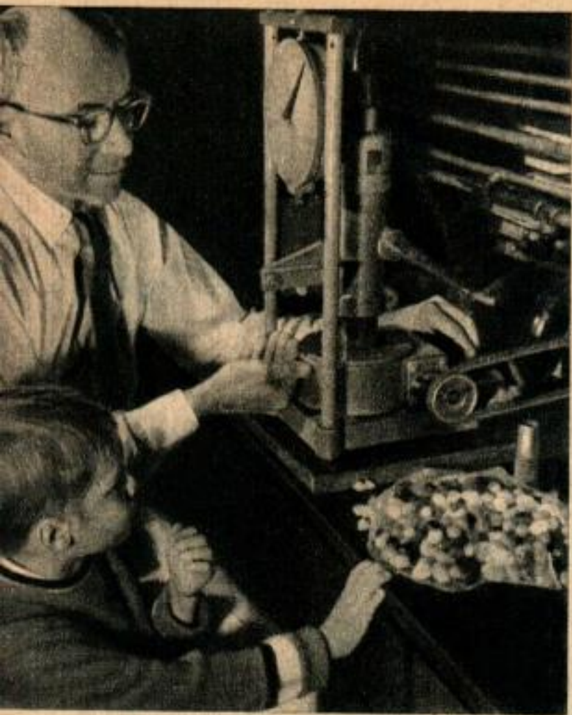
« L'essayeur de mordant » détermine l'aisance avec laquelle un produit peut être mâché ou coupé avec les dents. Un bifteck doit se couper sous 25 livres de pression, des bonbons entre 7 et 11 livres.
