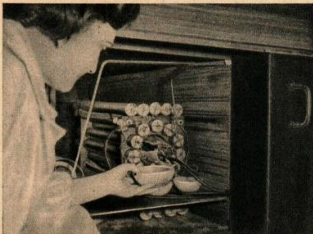
Cet appareil sert à déterminer l'âge des matières océaniques. Celles-ci sont brûlées; leurs gaz de combustion sont traités, et les isotopes de carbone radio-actif sont évalués au compteur de Geiger.
