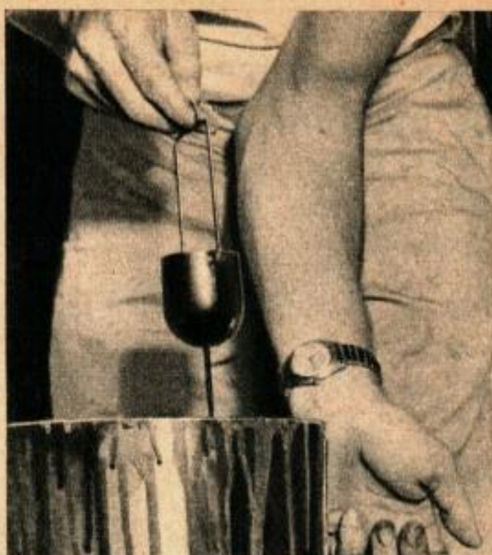
2. Pour obtenir la viscosité convenable pour le procédé du « coulage », le liquide est passé dans un viscosimètre. Sa vitesse d'écoulement à travers la coupe est soigneusement chronométrée.
