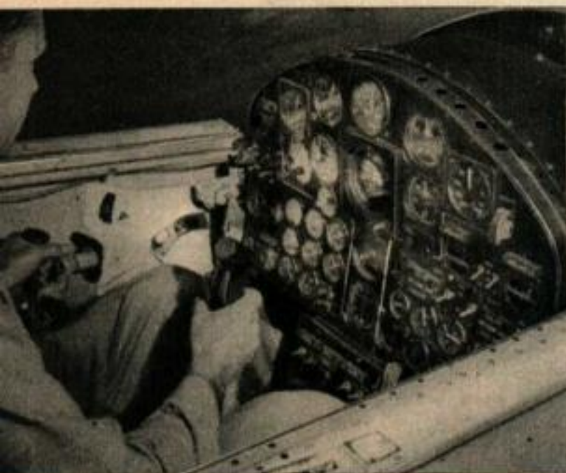
Un mécanicien terrestre vérifie les instruments de bord et les commandes du X-15 plusieurs jours avant qu'un nouveau vol soit prévu au programme.
