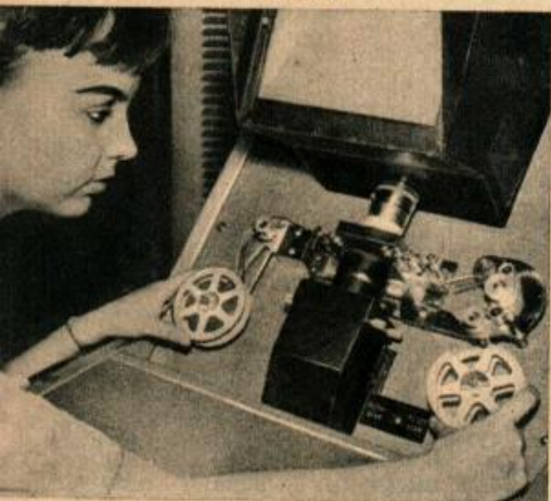
L'œil électronique de la machine FOSDIC détaille chaque cliché du microfilm. Ci-dessous, les opérateurs préparent une bobine de pellicule pour le décodage.
