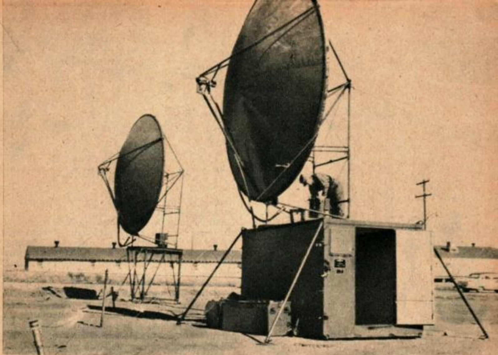
Ces antennes en caoutchouc gonflé utilisent leur surface intérieure arrière métallisée comme un réflecteur parabolique pour les communications radiophoniques à dispersion troposphérique. Elles peuvent être déballées, gonflées et installées en campagne en quelques minutes seulement.
