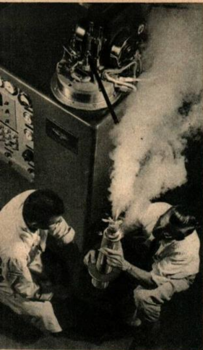
L'un des rares produits fabriqués par ADL est un liquéfieur à hélium permettant d'atteindre des températures aussi basses que -27^{\circ}\text{C} . Celui-ci est utilisé par 85 % des laboratoires de recherches sur les basses températures américaines.
