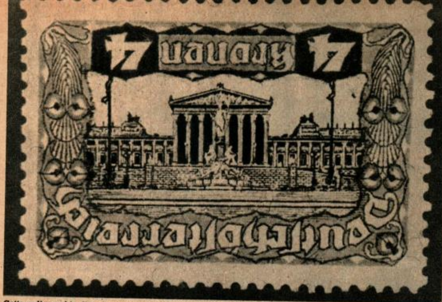
Cette radiographie d'un timbre autrichien montre comment le centre a été enlevé et inversé. L'adhésif utilisé est révélé par une ligne sombre.
