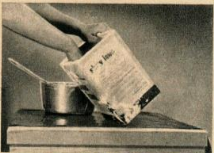
Ci-dessus, le modelage du plâtre à la main dans un moule fait d'une boîte en carton. Ci-dessous, lorsque le plâtre a pris, déchirer la boîte. À droite, lisser le dessus de la pièce coulée avec une lime et du papier de verre.
