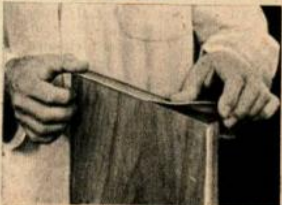
— Ci-dessous : garniture de bois veiné collé sur le bord donnant l'apparence de bois plein.
