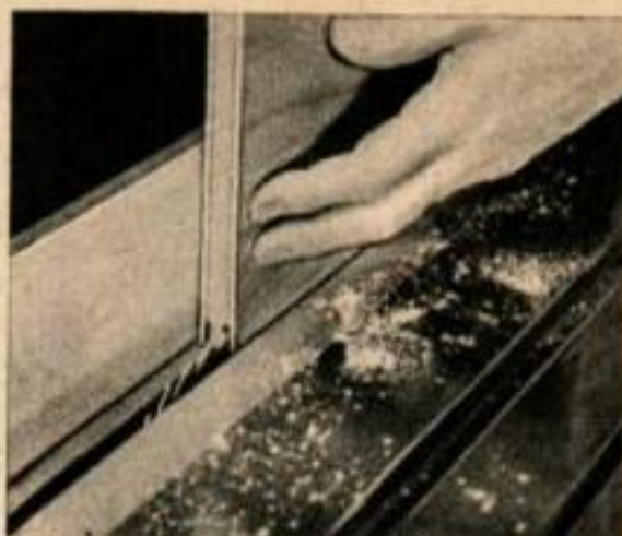
Ajustement soigneux de la lame de scie et découpe d'une rainure de façon simple.
