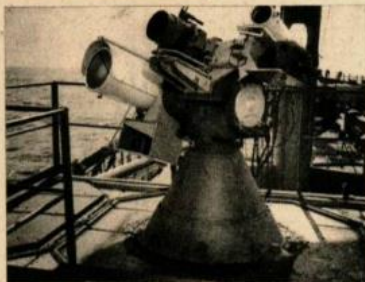
Par mauvais temps, un appareillage à rayons infrarouges repère le brûlant cône de pointe alors qu'il file dans l'espace.
