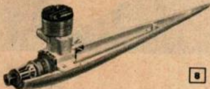
En dehors du dispositif de commande, voici les deux éléments additionnels qu'il vous faut acheter : un moteur de course et un carter inférieur en magnésium sur lequel sera boulonné le moteur. Les trous de montage sont d'abord percés, puis taraudés.
