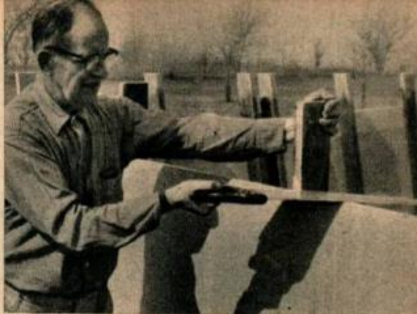
Les chutes d'extrémité des membrures latérales des couples et des entretoises de rigidité de proue et de poupe sont sciées en affleurement avec le dessus des panneaux de recouvrement. Les membrures latérales sont recoupées avec une inclinaison de 4°.
