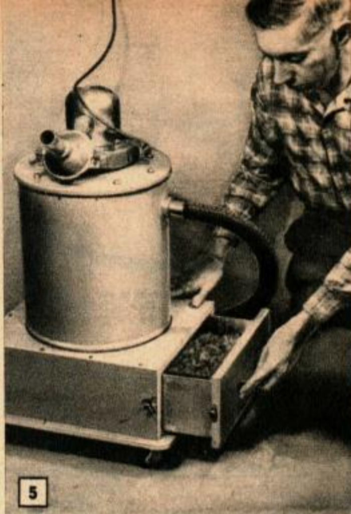
5 Le choix du moteur et du ventilateur d'aspirateur convenables reste largement à la discrétion du constructeur amateur. Cependant, le montage représenté dans cet article donnera une idée du type le plus facilement adaptable. Les figures 1 et 4 montrent comment le carter de la soufflerie a été recoupé pour adapter le groupe en vue de son utilisation sur le collecteur de
