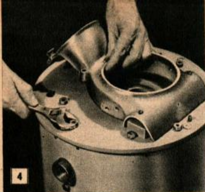
4 Les disques de contreplaqué sont boulonnés l'un à l'autre de façon à former un couvercle rigide. Remarquez comment le carter de ventilateur de l'aspirateur est fixé sur ce couvercle, ou dessous.
