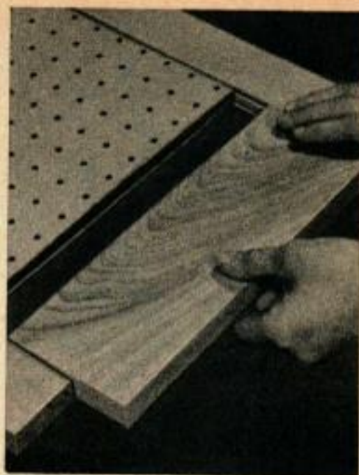
1. Les panneaux d'extrémité du paravent pliant comportent des plaques de fibre perforée doubles suffisamment espacées pour permettre l'insertion des crochets de suspension.
