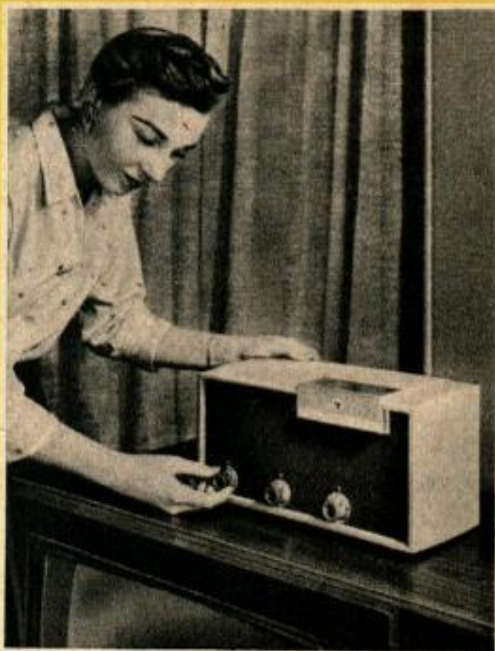
Le dispositif Telemeter placé au-dessus du récepteur T.V. permet d'ajouter trois canaux de T.V. payante, au choix, pour régulariser le coût de la T.V. libre.
