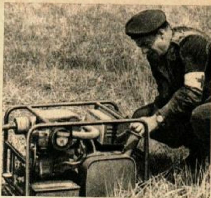
Ci-dessus : Un aviateur met la génératrice à 0,5 kW en marche. Ci-dessous : L'hôpital et la tente de mise en traitement ou en observation, prêts à recevoir les blessés.
