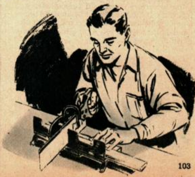
JOINTAGE ANGULAIRE À MI-BOIS AVEC ÉPAULEMENT : L'utilisation principale de cet assemblage est dans les charpentages lourds et dans le montage d'entretoises supportant de très lourdes étagères.
