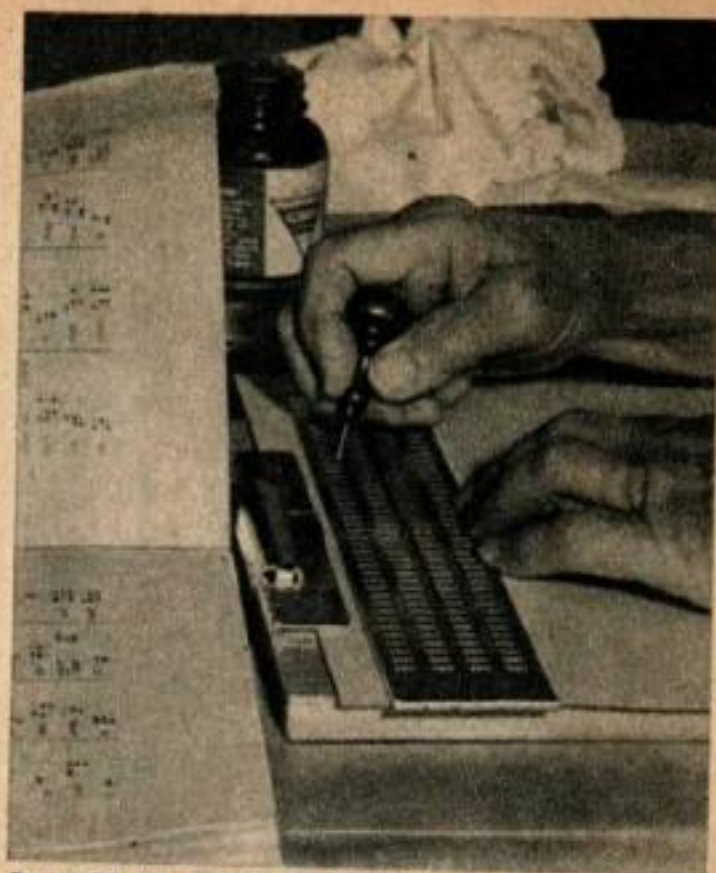
Le style, ou poinçon, est utilisé pour poinçonner des pointillés à travers l'ardoise de transcription en Braille. On aperçoit à gauche un guide de transcription.
