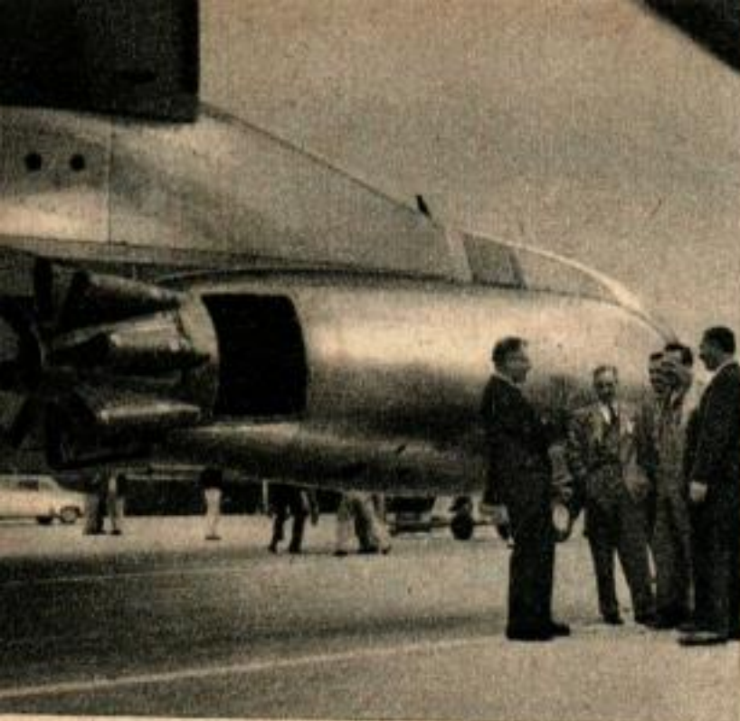
Le moteur à « turbo-ventilation » du Boeing 707 comporte un large capotage admettant un écoulement d'air supplémentaire autour du moteur. Ci-dessous, vue du moteur à turbo-ventilation montrant le capotage installé près de l'extrémité arrière.
