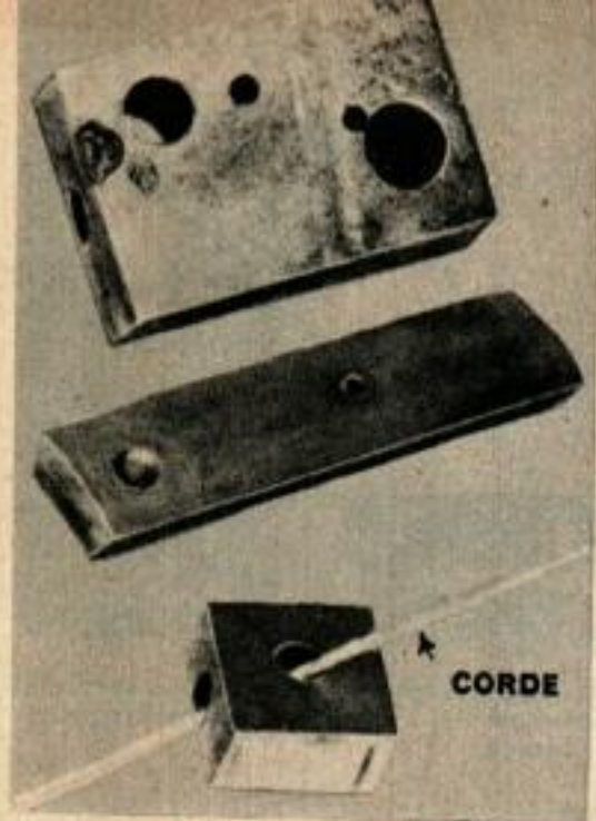
Quelques exemples de perçage et d'évidement électrolytique sur métaux extra-durs. La cordelette montre comment le trou pénètre dans une surface de la pièce et débouche dans une surface adjacente de celle-ci. A droite : Utilisation d'un micromètre pour vérifier l'épaisseur restante après fraisage chimique.
