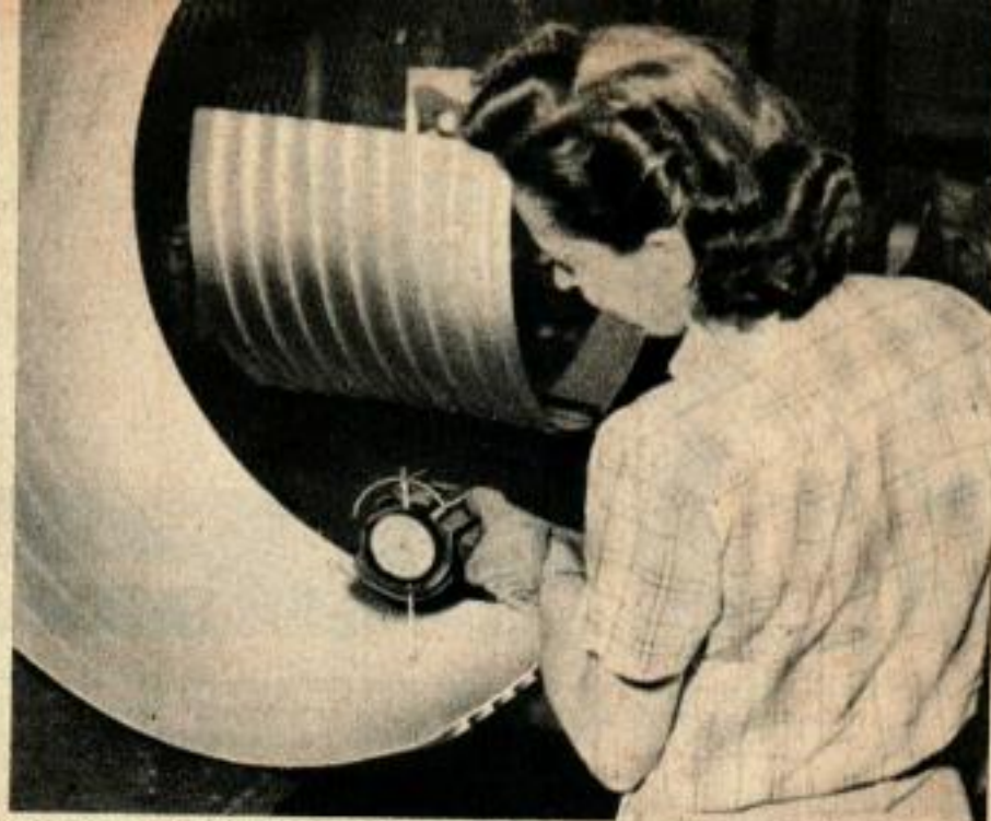
Quelques exemples de perçage et d'évidement électrolytique sur métaux extra-durs. La cordelette montre comment le trou pénètre dans une surface de la pièce et débouche dans une surface adjacente de celle-ci. A droite : Utilisation d'un micromètre pour vérifier l'épaisseur restante après fraisage chimique.
