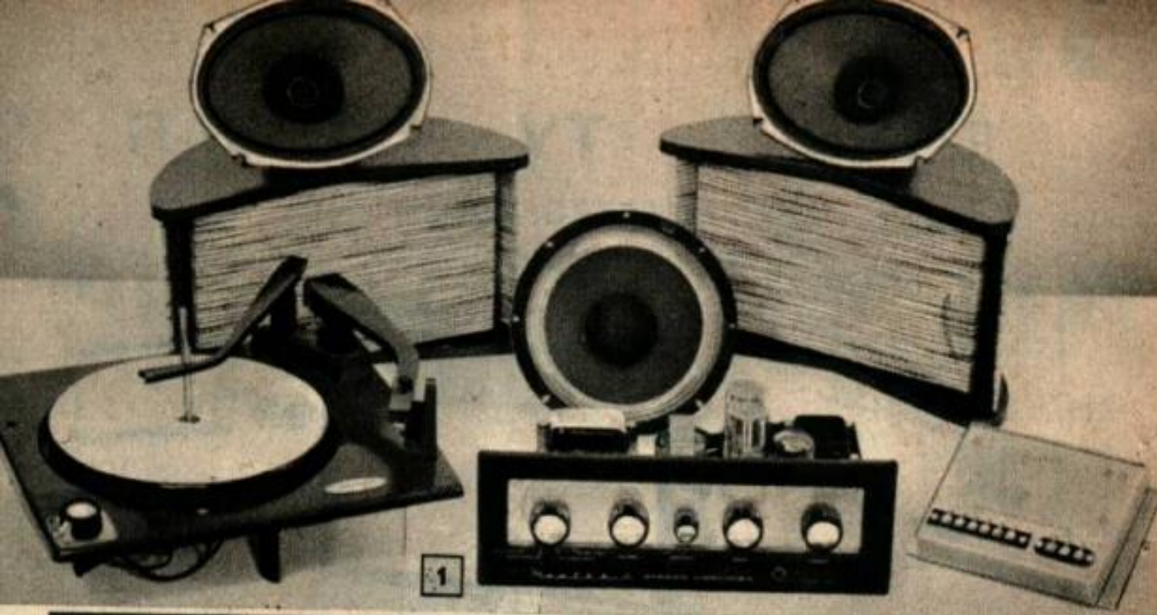
Eléments électroniques assemblables du jeu, comprenant la platine tourne-disque pré-assemblée avec tête pick-up stéréophonique, amplificateur, réseau de filtrage pour haut-parleurs et système de trois haut-parleurs.
