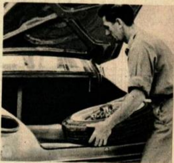
Vue de derrière de la Valiant. La roue de secours se loge dans un bac aménagé dans le plancher. Le couvercle de la malle s'incline fortement entre la fenêtre arrière et le pare-chocs.
