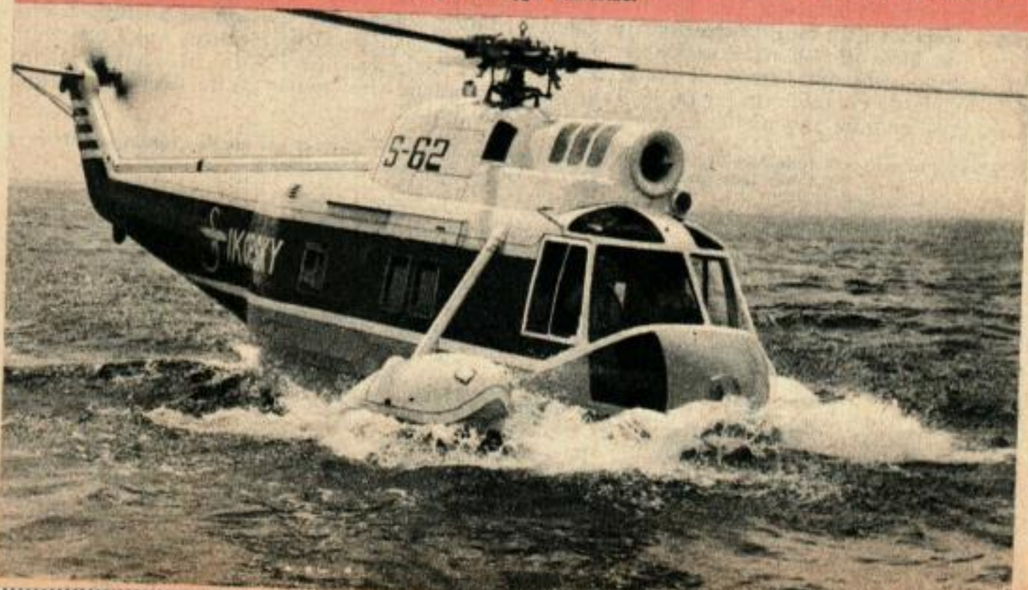
La coque de cet hélicoptère amphibie propulsé par turbine et présenté cette année au public pèse moins que la coque du type terrestre.
