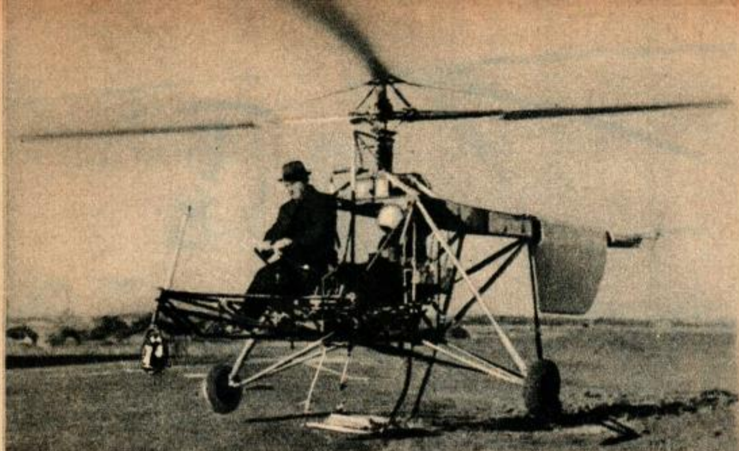
La première tentative sérieuse vers le vol vertical fut le VS-300, montré ci-dessus alors qu'il est encore ancré sur le sol pour plus de sécurité.
