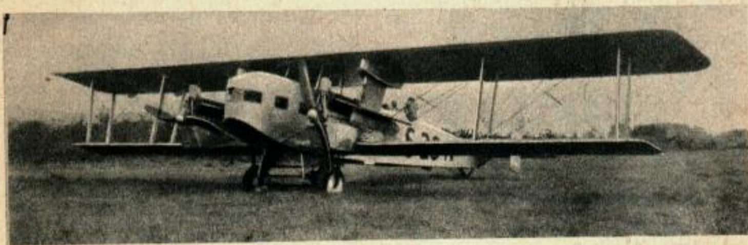
Le premier avion Sikorsky fabriqué en Amérique fut le S-29, avec une carcasse construite en tubes et cornières récupérés à la ferraille. Il s'écrasa au sol lors de son premier vol à cause d'une surcharge en passagers auxquels Sikorsky n'avait pas eu le courage de refuser une place
