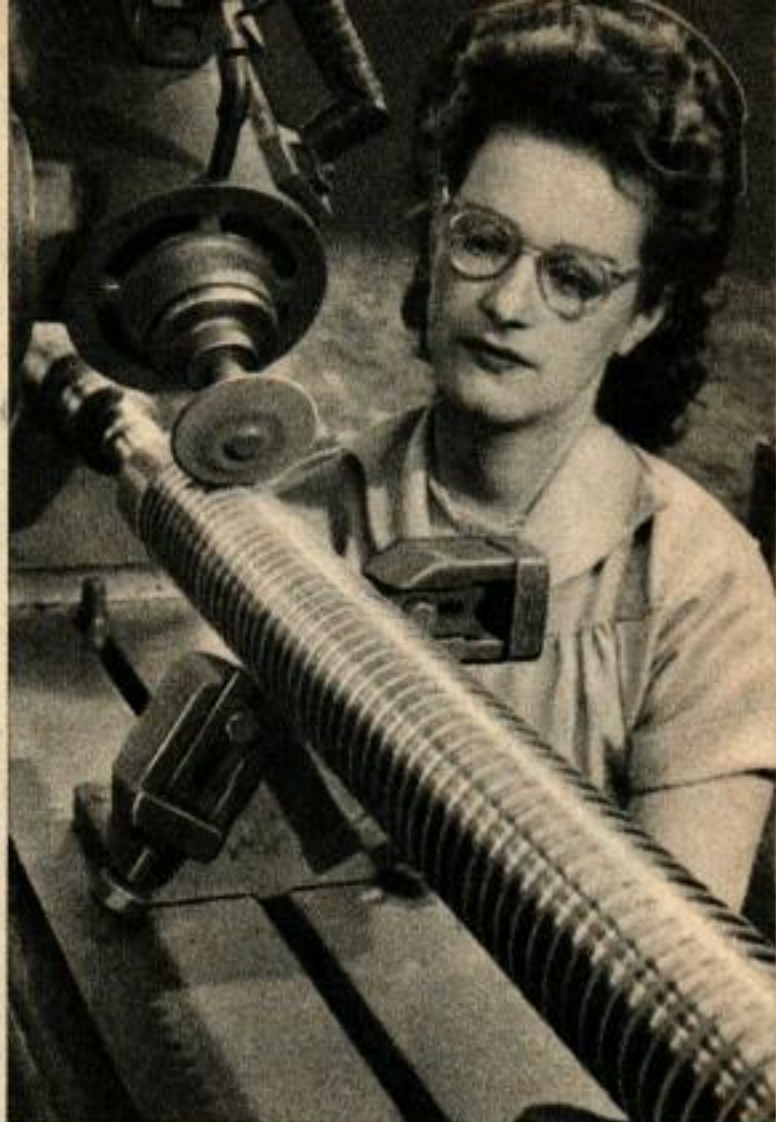
Ci-dessus à gauche : Vérification finale du parfait alignement d'une lame de scie à dents au carbure de tungstène. Cette scie spéciale est utilisée pour trancher des ailettes de refroidissement dans les pistons des moteurs. À droite : Un disque abrasif tournant à haute vitesse meule les dents d'un élément de 1,50 m.
