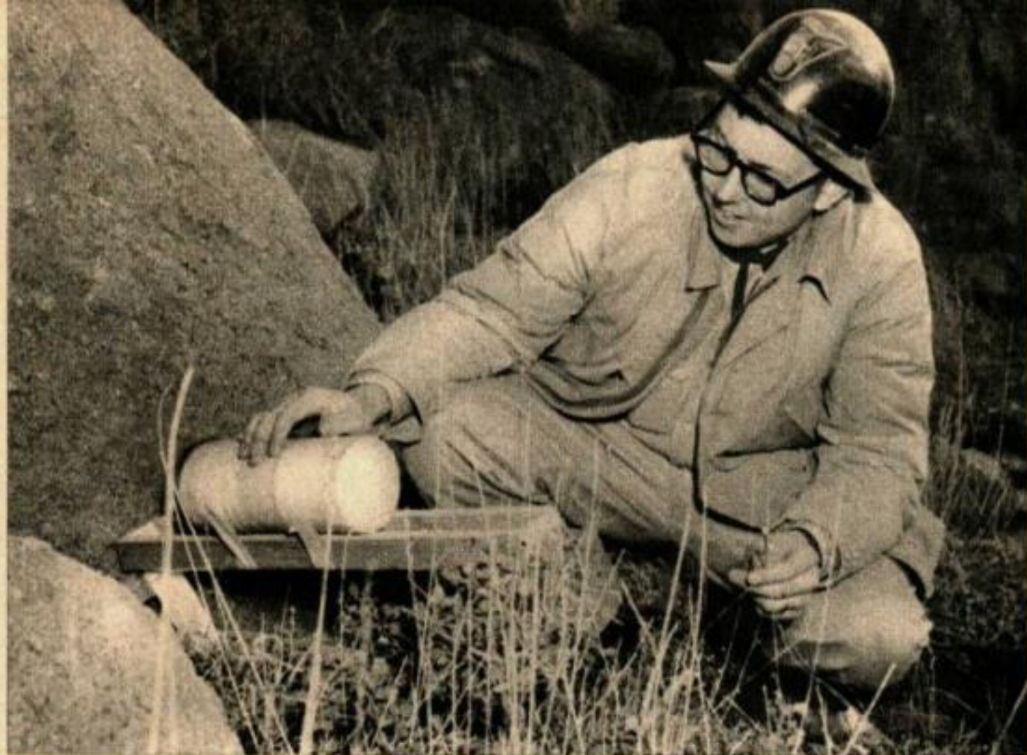
Le Docteur Carl Austin se prépare à faire détoner une charge qui utilise les principes de tir du bazooka pour forer des roches extrêmement dures.
