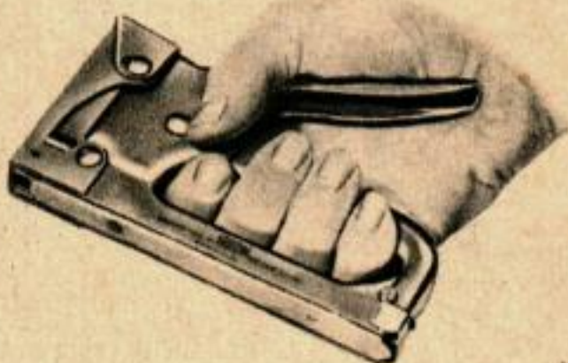
1. La fixation rapide des carrelages de plafond par leurs rebords dissimulés n'est qu'un seul des nombreux travaux pour lesquels il est idéal d'utiliser un pistolet agrafeur.
