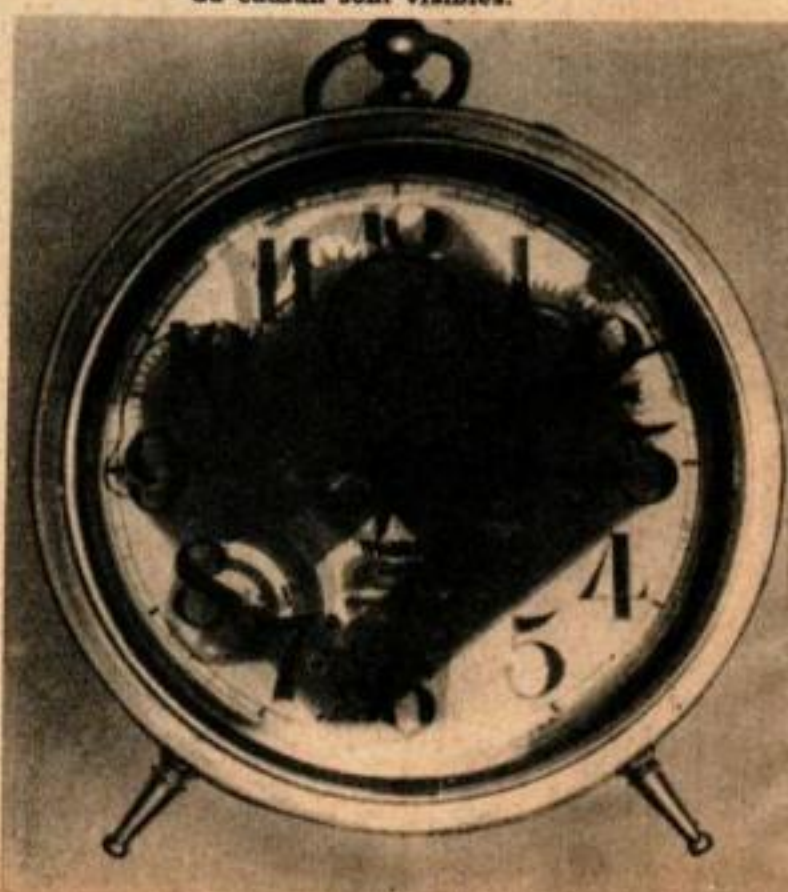
Les pièces intérieures de ce réveil cachent les aiguilles dans cette photoradiographie, mais tous les chiffres du cadran sont visibles.
