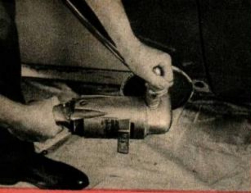
Lorsqu'un métal plastique tel que le fer liquide est utilisé pour les réparations de carrosserie d'automobiles, la surface à traiter doit tout d'abord être poncée.
