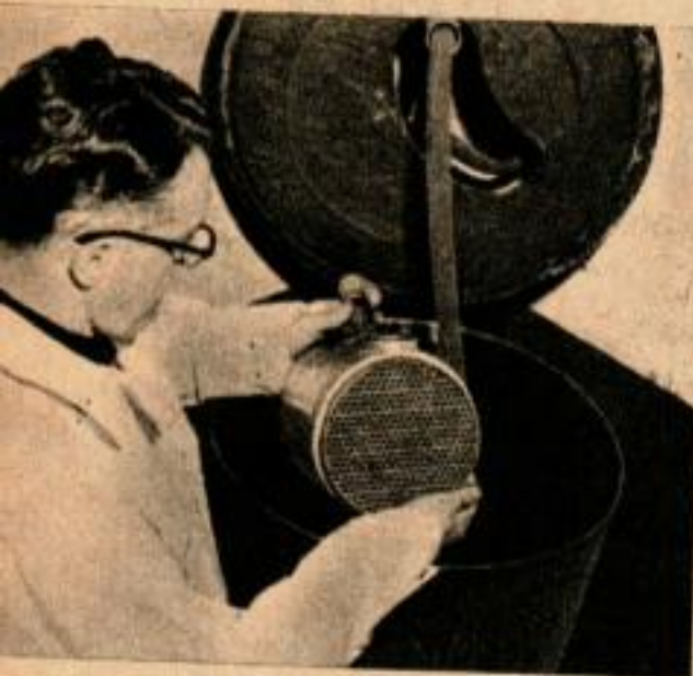
Les radiateurs de refroidissement d'huile des appareils de l'A.C.A. sont nettoyés dans une simple machine à laver. Celle-ci fait circuler le liquide de nettoyage à travers tout le radiateur.
