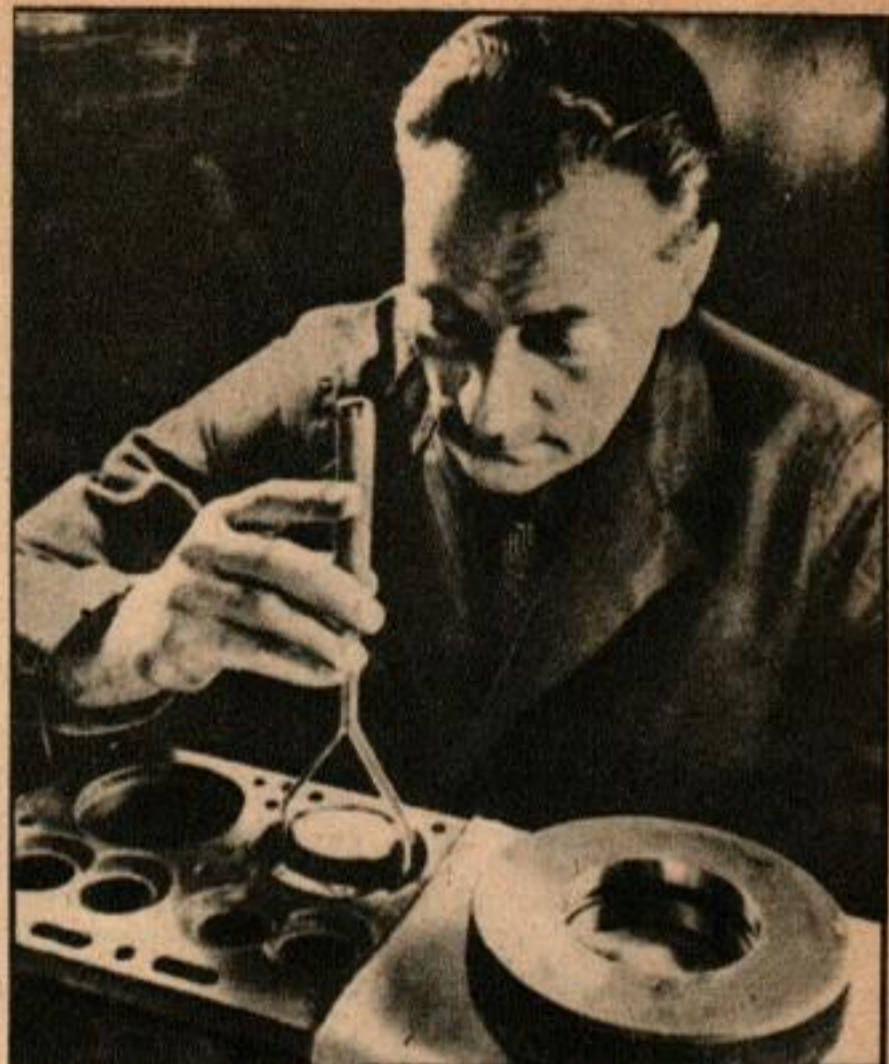
La jauge montre l'usure des cylindres avec une approximation de 1/1000 e de mm.
