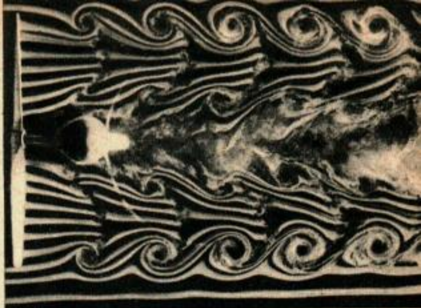
Sur cette figure, un modèle d'hélice d'avion tourne à 4 080 tr/mn. La fumée forme des motifs parfaitement organisés, prouvant que des volutes distinctes se forment, et que le motif se répète précisément et indéfiniment tant que l'hélice se déplace dans l'air.
