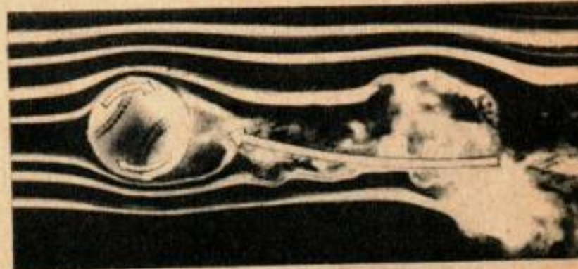
La turbulence montre que la balle en rotation suivrait une trajectoire incurvée vers la droite. Une balle non tournante avec la couture se trouvant à la position indiquée suivrait une trajectoire fortement incurvée.
