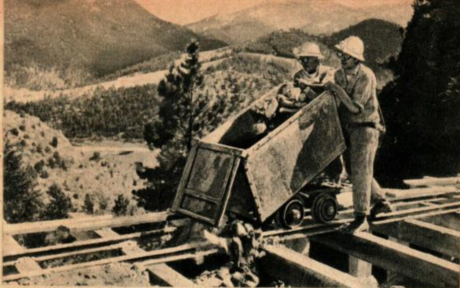
Les élèves apprennent aussi les techniques d'extraction manuelle. Ici, le minéral pelleté à la main est déversé à la main.
