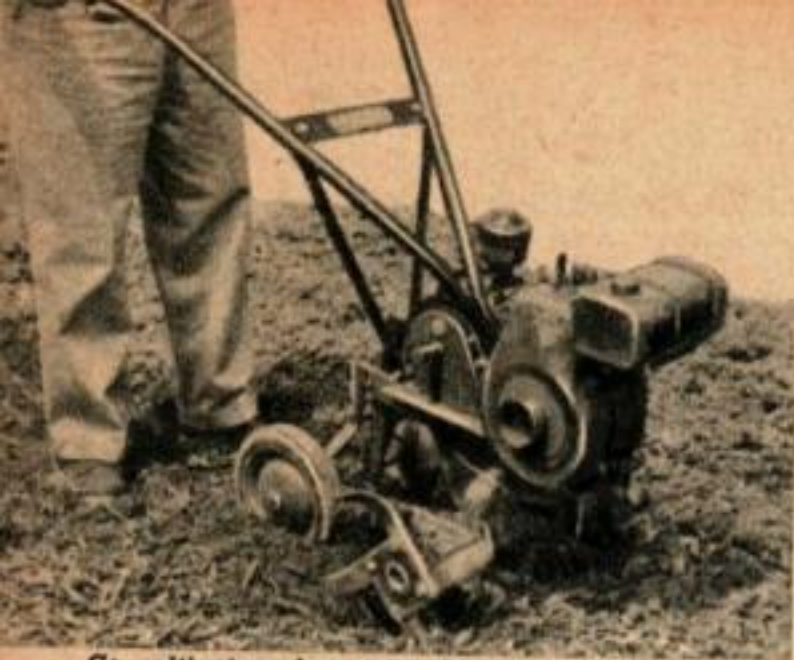
Ce cultivateur à moteur incorpore les copeaux de bois au sol d'une nouvelle pelouse. Ce traitement est particulièrement précieux pour l'amendement des terrains très argileux.
