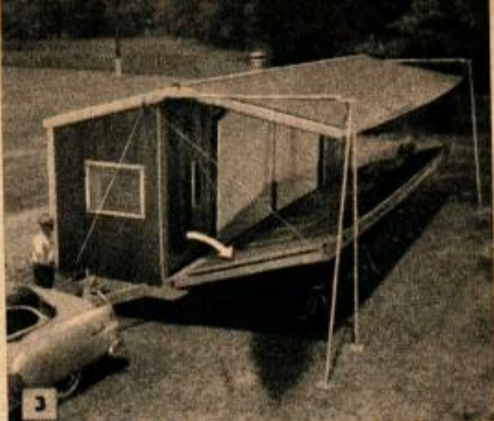
3 Deux personnes sont nécessaires pour actionner les treuils montés à l'avant et à l'arrière de la remorque. Dans la photo ci-dessus, le plancher et la paroi extérieure sont en cours d'abaissement après que le toit a été relevé.
