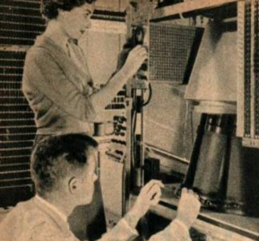
Le prototype de « dispositif d'emmagasinement à taches volantes » (points projetés par un pinceau lumineux) de la centrale téléphonique est un élément vertical que l'on voit ci-dessus.
