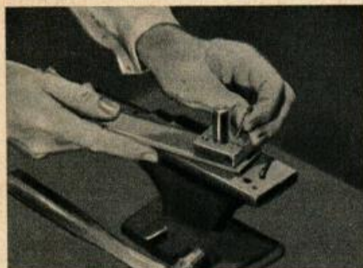
Ci-dessus : Le porte-poinçon est mis en place au moyen d'une broche d'alignement de 12 mm avant d'être riveté en position sur le bras supérieur. Ci-dessous : Le porte-poinçon est fendu de façon à fonctionner comme une pince de serrage pour tenir le poinçon en place. Remarquer la position des bras.
