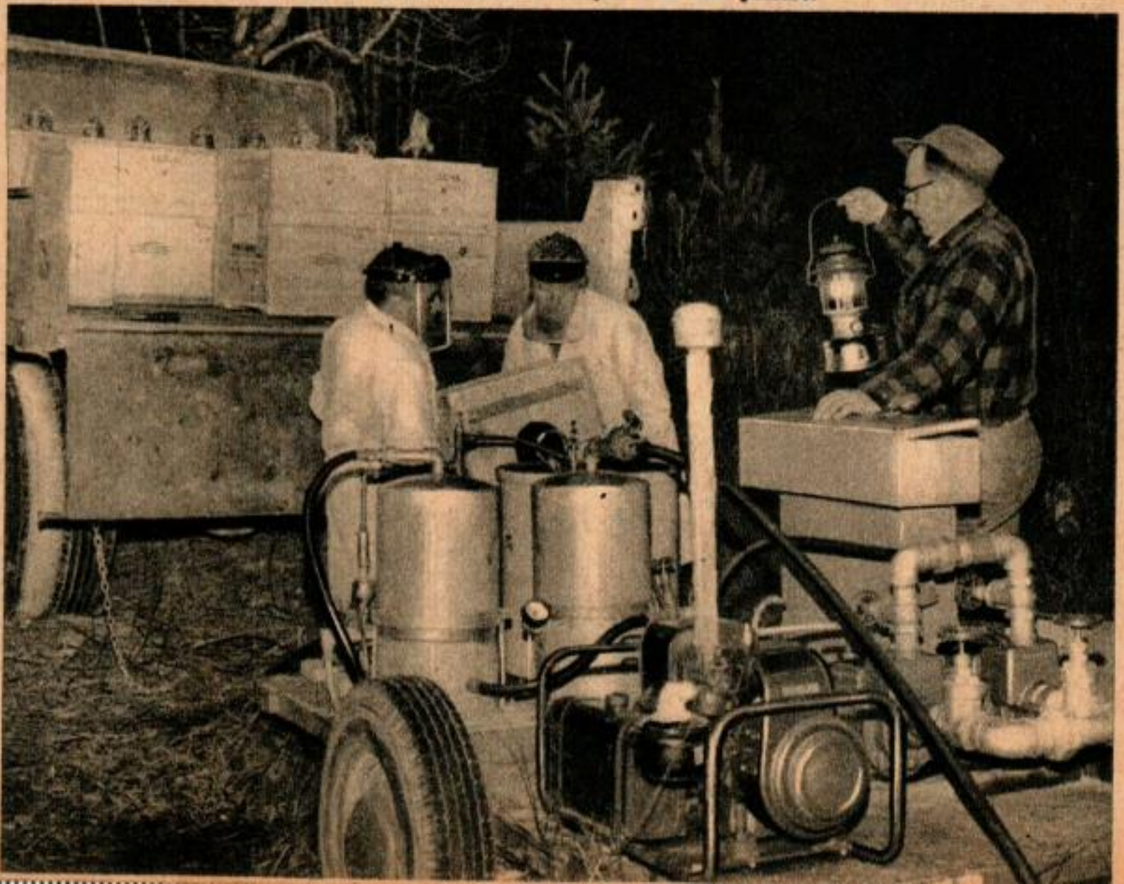
Cette machine portable équipée de dispositifs de distribution mesurée des liquides chimiques distribue le poison sur le lit des rivières au moyen d'un tube perforé.
